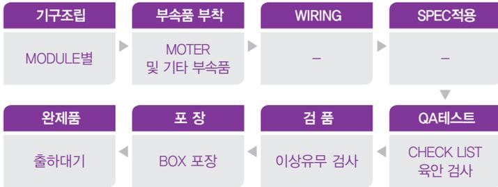
YAW, BODY, LEVEL, SENSOR 각 모듈별로 기구를 조립한 후 모듈 간에 조립을 한다. 그 후 MOTER 및 기타 부속품들을 부착하는 공정을 거쳐 WIRING작업 및 SPEC적용, CABLE정리 및 BUC, LNB를 적용하는 공정을 실시한다. 체크리스트를 작성해서 육안검사와 기타 테스트를 하는 QA테스트를 거쳐 검사를 완료하고 포장을 하면 제품이 완성된다
