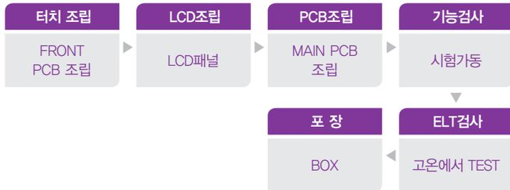
FRONT PCB를 비롯한 TOUCH조립 공정을 거쳐 LCD를 조립해준 후 LCD패널 및 메인PCB와 각종 BRACKET을 조립하면 반제품이 완성되는데, 1차 기능검사를 통해 시험 가동
